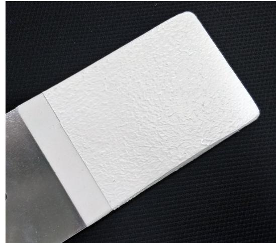
针对汽车车体轻量化、环保、节能的设计要求，利用气凝胶绝热材料优势对汽车车架、车顶、底盘、乘员舱、排气管道等进行喷涂气凝胶隔热降噪涂料，可起到隔热保温、隔音降噪、减震、提高整车安全系数及车内舒适度等，达到冬季保温、夏季隔热，降低车辆空调能耗的作用。
