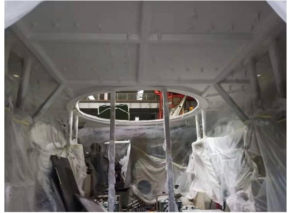
主要应用于特种车辆及各类汽车的乘员舱、顶棚、底盘里外等的结构隔热、减振降噪和表面防护，实现夏季隔热效果好，降低空调能耗及公里油耗。
