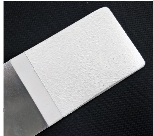
针对汽车车体轻量化、环保、节能的设计要求，利用气凝胶绝热材料优势对汽车车架、车顶、底盘、乘员舱、排气管道等进行喷涂气凝胶隔热降噪涂料，可起到隔热保温、隔音降噪、减震、提高整车安全系数及车内舒适度等，达到冬季保温、夏季隔热，降低车辆空调能耗的作用。
